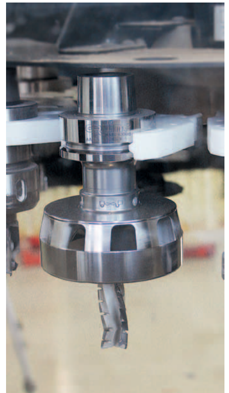
Abb. 1: Spannzanze mit Turbine: Mit Hilfe des Aerotech-Systems von Cruing wird der Spänestrahl gestoppt und gezielt nach oben gelenkt (Foto: Cruing) (Hinweis: Die Abbildung 1 wird nachgereicht)
