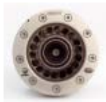
Das ringförmige Gitter weist Reststücke ab
