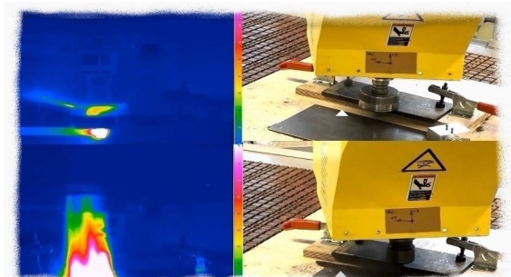
Thermographie: Der Staub fliegt seitlich leicht aufwärts
