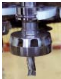
Kompakt: HSK-Aufnahme, Turbine und Schafffräser
